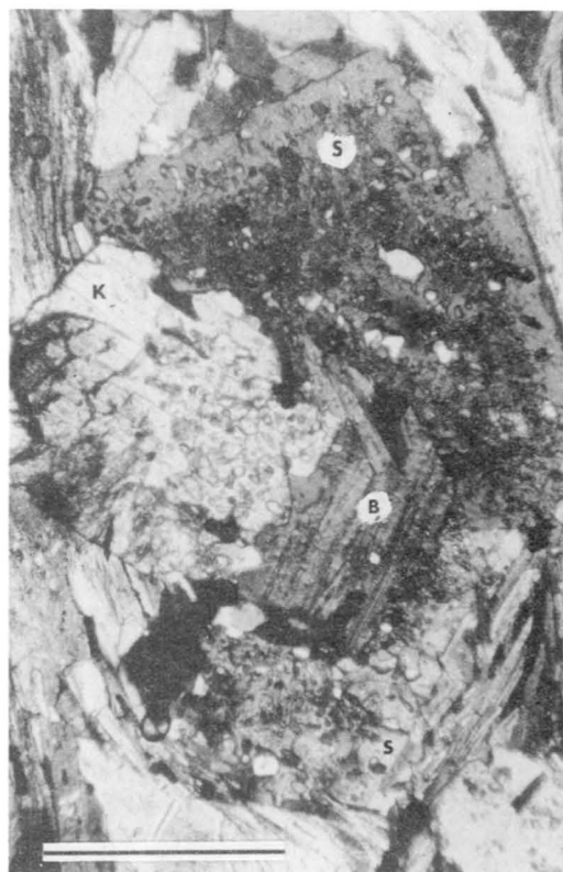
Fig. 31. Mikroskopfoto fra tynnslip av granat-staurolitt-kyanittglimmerskifer fra Duksfjordformasjonen (575834). Bildet viser en staurolitt krystall (S) som delvis har blitt brutt ned ved økende metamorfose til kyanitt (K) og biotitt (B). Planpolarisert lys. Skalaen er 0,5 mm.
