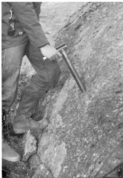
Fig. 9. Mest vanlig brukte scintillometer av type "Knirps" fra Gewerkschaft Brunhilde. Krystallstørrelsen er 25 mm x 25 mm. Registrering kan skje digitalt eller med viser. A 'Knirps' type scintillometer (Gewerkschaft Brunhilde) most commonly used as hand instruments during field work. Crystal size is 25 mm x 25 mm. Registration is read digitally or by meter.
