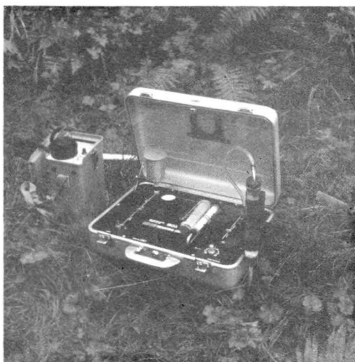
Fig. 12. Utstyr for måling av radon i jordluft og vann (EDA RD 200). For måling i vann trengs avgassingsenheten i kofferten mens selve måleenheten er til høyre på bildet.
