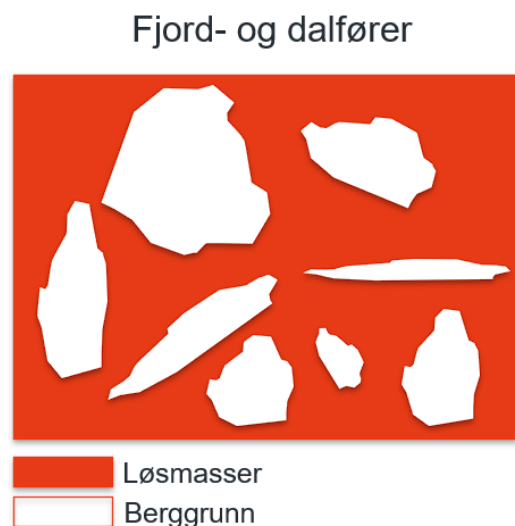
Figur 7. Prinsippskisse som viser teknisk tilnærming til kartlegging i landskapstypen fjord- og dalfører. I slike områder skilles berggrunnsblotninger fra omliggende løsmasser.
