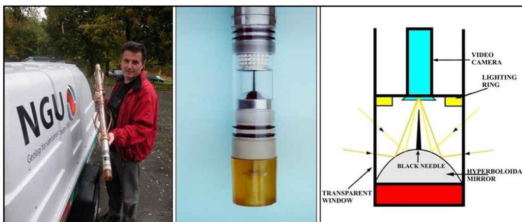
Figur 6.1: Bilder og prinsippsskisse av en optisk televierer (OPTV).
