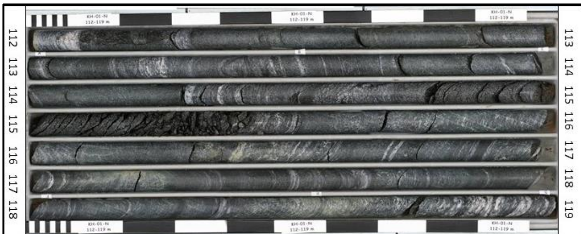
Figur 6.19: Bilde av borekjernene fra borehull KH-01-N, 112 m til 119 m. Kjernene viser kraftig oppsprekking fra 114,7 til 115,4 m, men normal oppsprekking både over og under dette nivået.
