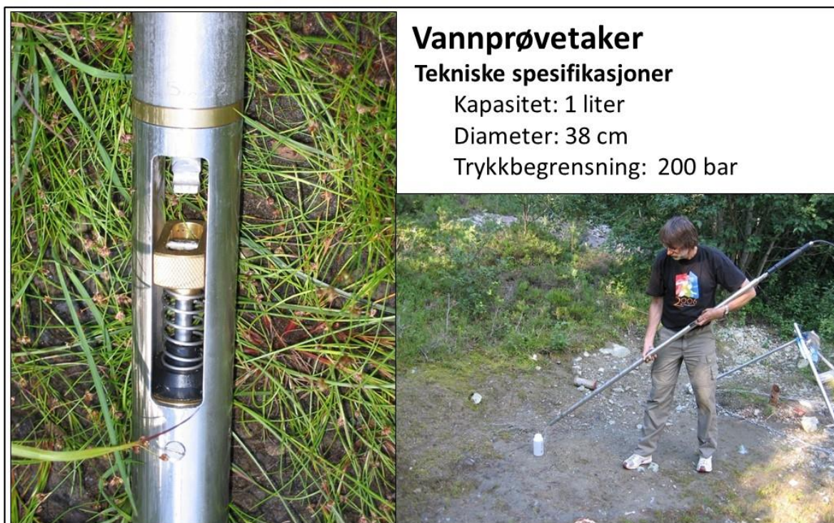
Figur 6.32: Bilder av vannprøvetaker fra Robertsson Geologging. Vannprøve kan helles på flaske uten forurensende kontakt. (Foto: NGU).
