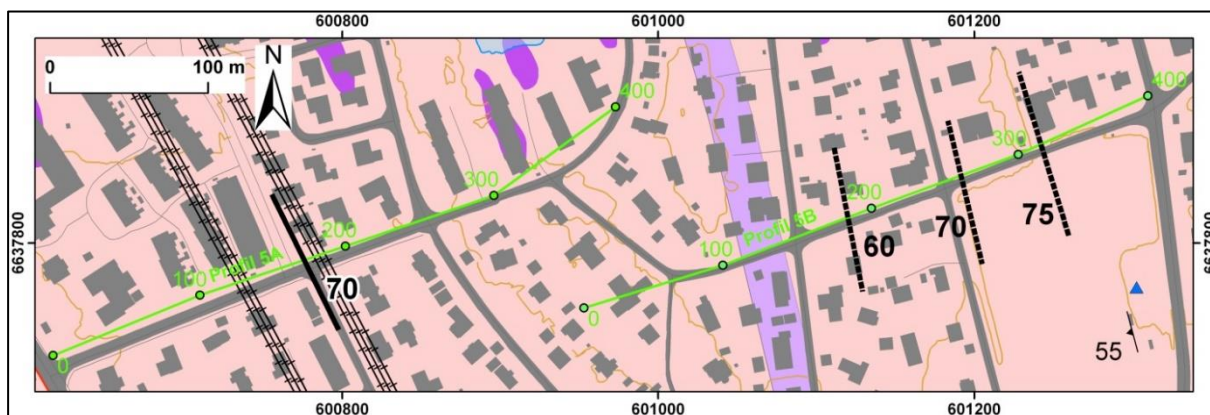
Figur 3.37: Lokalisering av resistivitetsprofiler over «Follobanen» angitt som grønne linjer. Profil 18 i åpent terreng (øverst) og Profil 5A i tettbebyggelsen på Ekeberg (nederst). Tunneltrasé er vist som tynne sorte streker. Sorte stiplede streker viser tolkede svakhetssoner med tolket fall angitt i grader på fallsiden (Fra Saintot m.fl. 2011).
