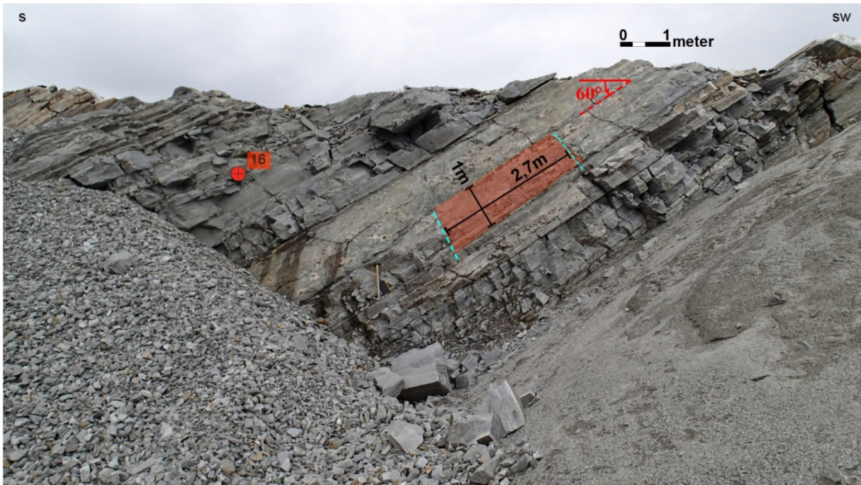
Fig. 10: Bilde viser midten av stoffen, hvor prøve 16 er tatt. Merk den varierte tykkelsen og den naturlige blokkstørrelse og blokkform, som er bestemt av kløven. Kløven er parallell med fallet i lagene, som er ca. 60 grader, og sprekkene kutter tvers i gjennom lagene.
