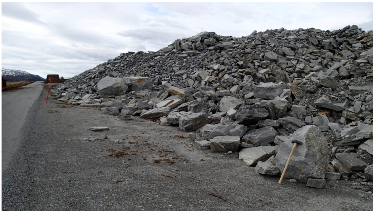
Fig. 17: Typiske blokkstørrelser (Steintipp, vist på Geologisk kart). Størrelsen varierer fra grus til store blokker med mer enn 1 meter i diameter (hammer størrelse: 80 cm). Større steinheller har en regulær form på grunn av de kontinuerlige bruddflater, mens enkelte av de massive kvartsrike lag ikke har uttalt kløv som gir mer uregelmessig oppsprekking og uregelmessig formede blokker som vist i nedre høyre hjørne. Bilde mot sør-vest.
