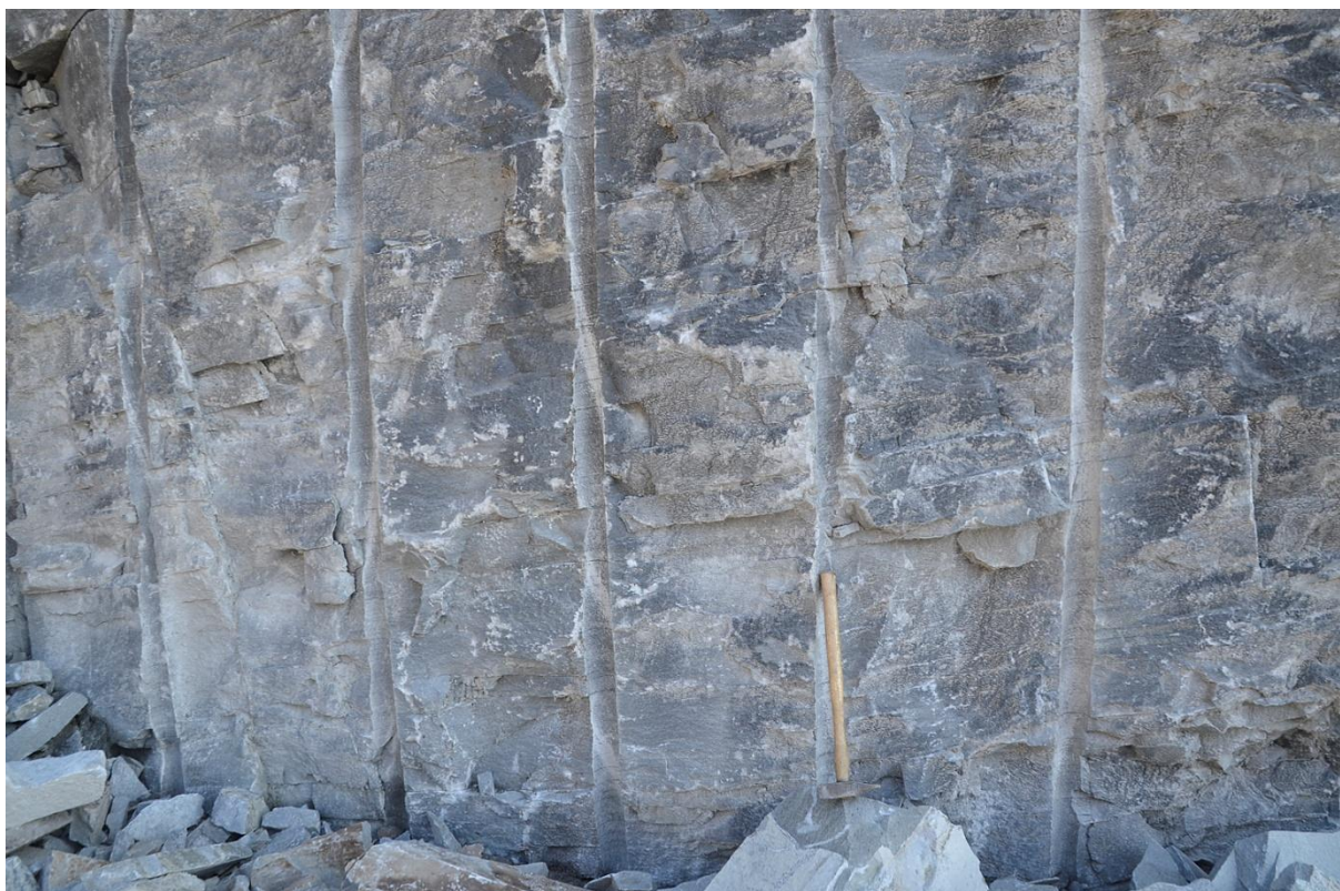
Figur 15: Del av veiskjæringen i Figur 13 som viser god spalting på 1-4 cm skala.
