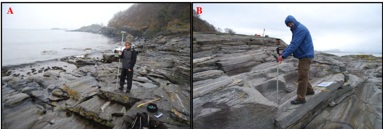
Fig. 17. A. Utsetting av fastpunkter med Leica-GPS. B. Innmåling av kvernsteinsuttak/"tomter" med Leica-Totalstasjon. Vasskvernene, her med diameter på 90 cm, er tatt ut direkte fra "benker" i berget (fotos: LP-D).
