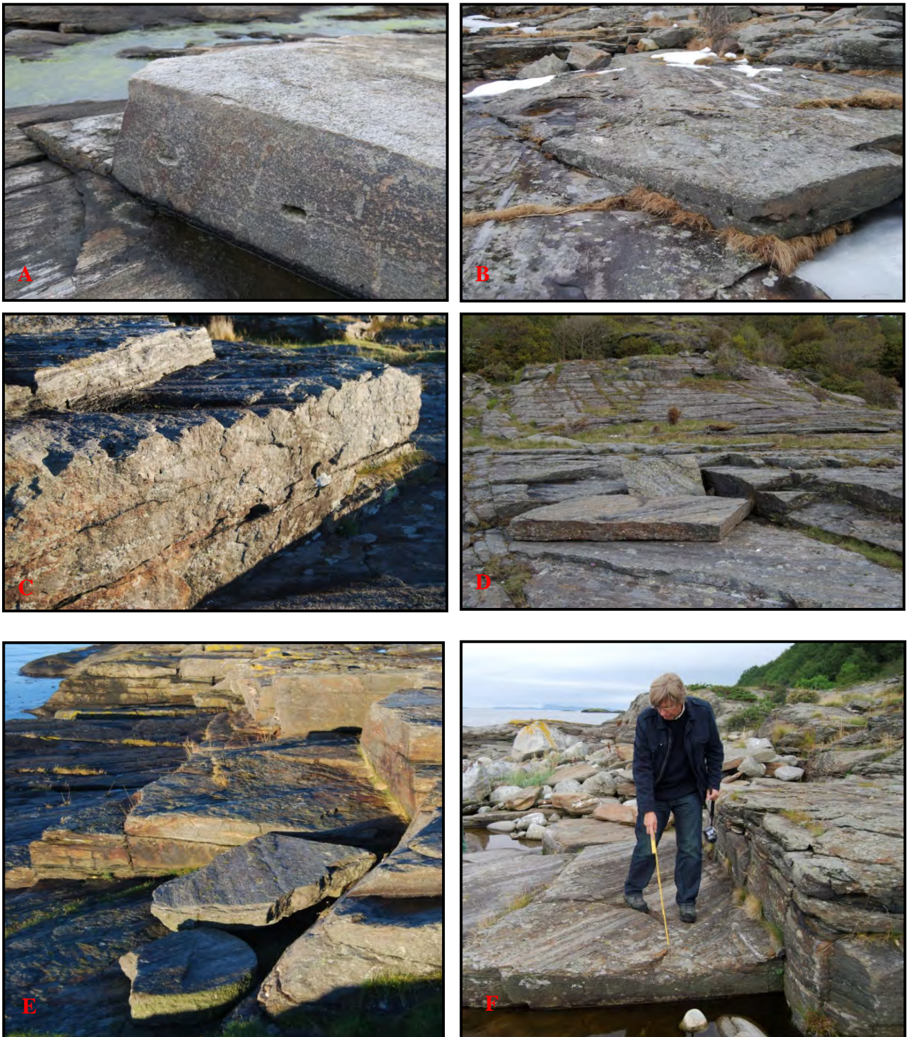
Figur 16. Fremstilling av kvernstein fra løsblokk eller utkilt blokk i delområde B: A og B. Splitting horisontalt med kløven med meisel. C. Merker etter bruk av meisel. D og E. Kilt emne til kvernstein samt ferdig bearbeidet emne (mislykket) F. Perimeteren til vasskvern satt i blokk, skrottpipp i bakgrunnen (fotos: LP-D).
