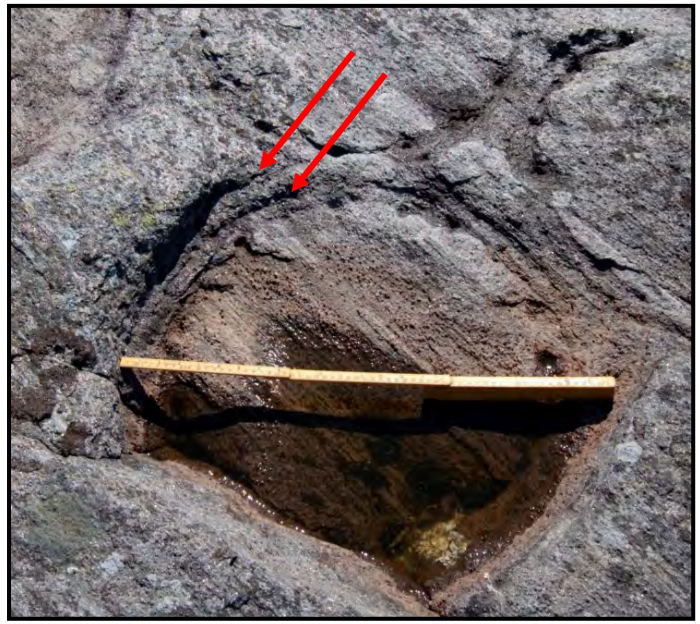
Figur 10. A. Prinsipp for hogging av en W-formet kanal hvor "ryggen" mellom sporene slås eller brekkes av. B. Eksempel på W-formet kanal som står igjen etter at emnet er fjernet.
