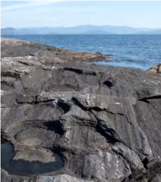
Figur 12. Eksempel på hogging av kanal i flere omganger. Legg også merke til at emneuttakene følger kløven i ulike plan, delfelt A (foto: LP-D).
