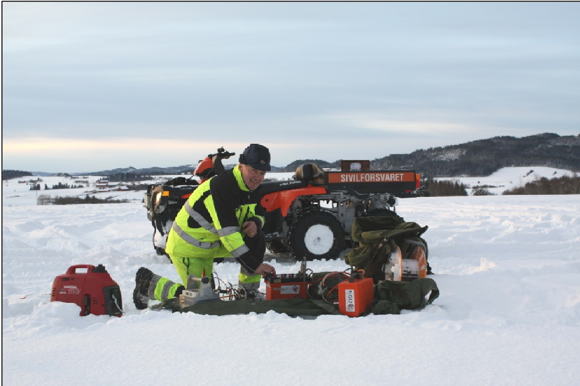
Figur 4. Resistivitetsmålinger ved skredgropa på Byneset i januar 2012. Målingene ble utført på snødekt mark uten tele (Foto: Einar Dalsegg).
