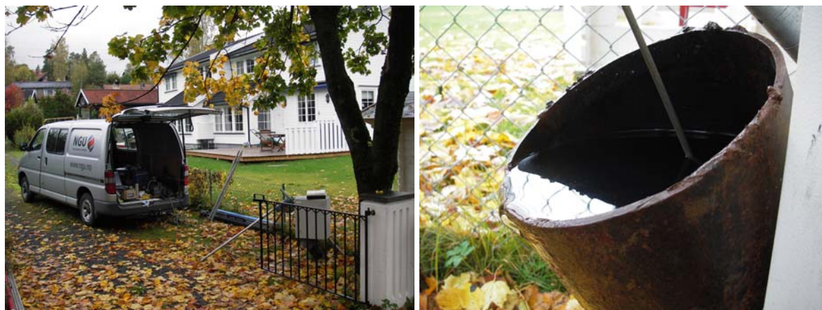
Figur 2. Storengveien 53A. Logging av brønn, til venstre og artesiske brønn (utstrømning av vann) til høyre.
