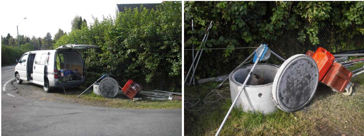
Figur10. Logging av brønn i Storengveien 30A..
