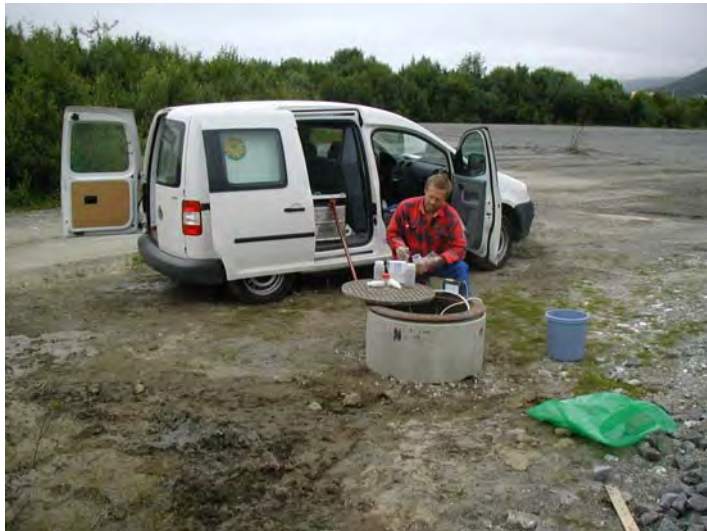
Figur 11. Prøvetaking av grunnvann fra Brønn 2.
