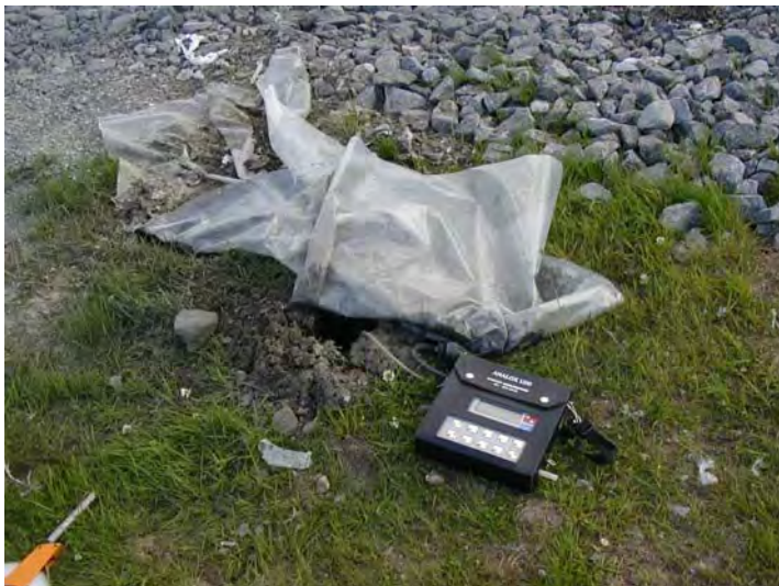
Figur 14. Måling av gassammensetning i felt ble utført ved å føre slange fra instrumentet 0,3 – 0,5 m ned i hullet.
