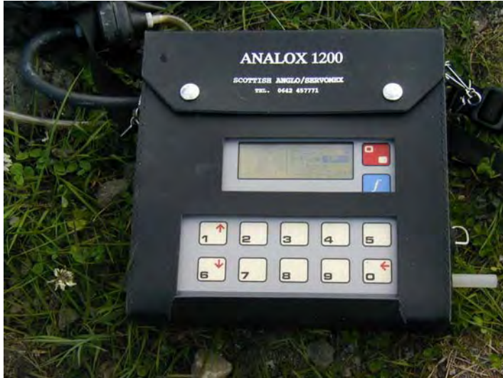
Figur 13. Måling av gassammensetning ble gjort med instrumentet Analox 1200 fra Geotechnical Instruments Ltd.
