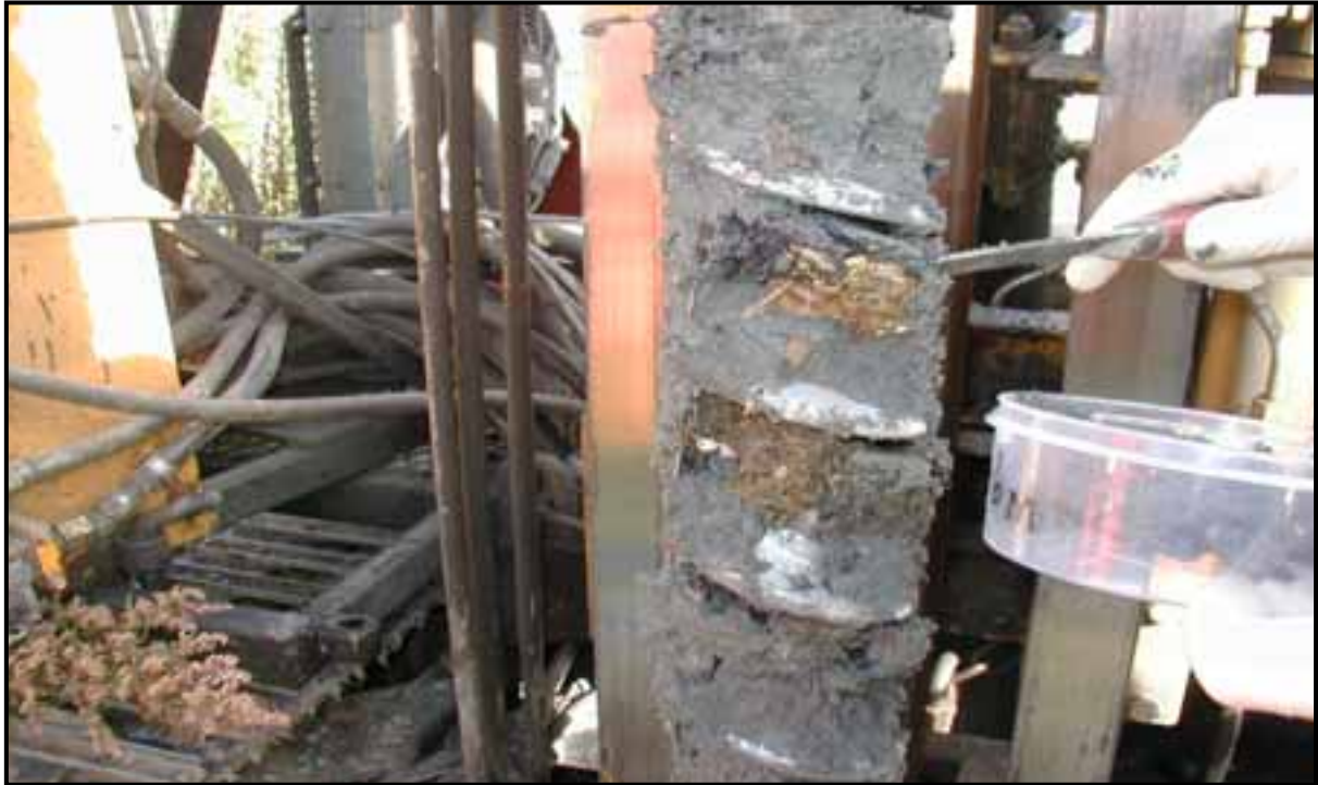
Figur 6 Eksempel fra prøvetaking ved boring i Ladefyllingen. Foto NGU.
