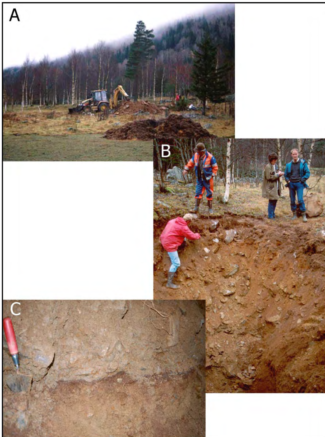
Figur 2. (A) Graving på Gaustadjordet; (B) Gravegrop på Gaustadjordet; (C) Jordprofil fra gravegrop på Moe, med et brunt jordlag mellom to jordskredavsetninger. Foto: S.Dahlgren.
