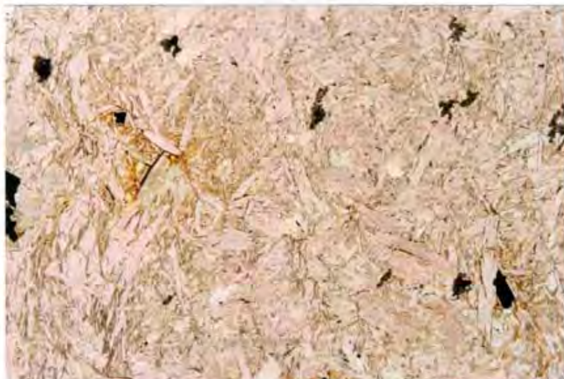
Bilde 1 2,5x objektiv, II-lys. Prøve/slip nr. Linna 101A: meget talkrik (tlc) kleberstein med lite karbonat.
