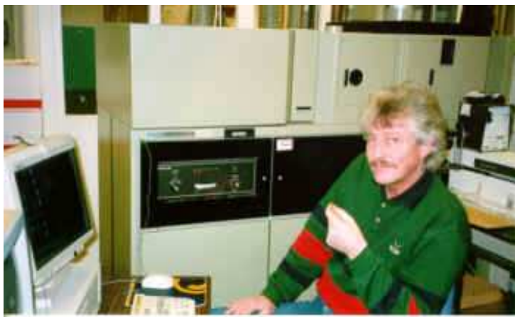
Bilde 2. Jordprøvene ble oppløst i salpetersyre, og innholdet av arsen, kadmium, krom, kobber, kvikksølv, nikkel, bly og sink ble bestemt ved hjelp av plasm-spektrometri og atomabsorpsjon-spektrometri.
