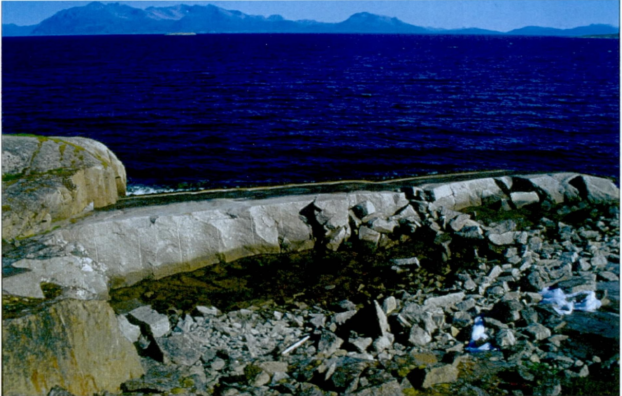
Figur 2. Gammelt brudd ved Seglhjellen (sjosiden). Bildet viser granittens oppsprekking og benking i de mer massive områder.
