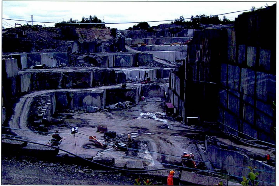
Linesaging benyttes til oppdeling av store Larvikittblokker i Vestfold.
