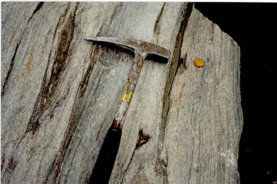
Figur 12 Kvartsskifer med dårlige spalteegenskaper og foldete lag med glimmerskifer, Jøndalen.
