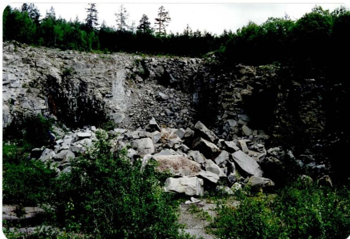
Figur 2 NSBs brudd nordøst for Dombås. Merk sprekketetthet og terrengparallel benkning (eksfoliasjon)
