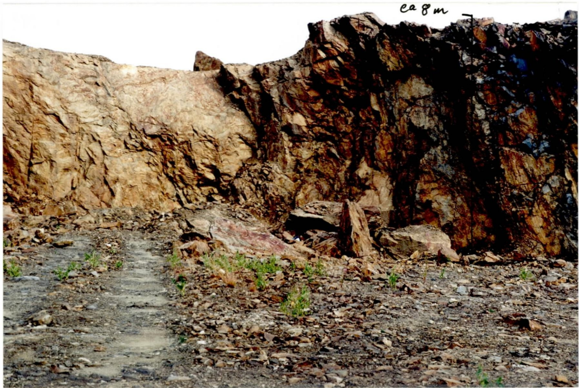
1: Industriområdet Svabekk/Kirkemyr. Steinbrudd med omfattende rustdannelse. Bruddet åpnet 1988. Pallhøyde ca. 8 m (foto H. Breivik).
