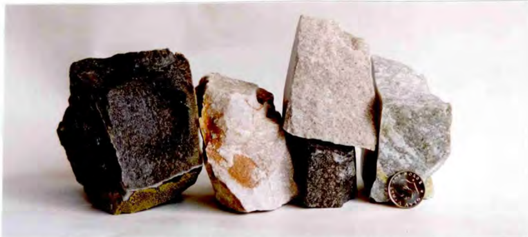
Figur 3: Fargevariasjoner i kvartsitter fra Finnmark; A viser de lyseste variantene i Gamasfjell: til venstre helt hvit fra toppnivået (Tananes), i midten en glassaktig, grå variant fra ukjent nivå (Cap'pirgåp'pi, Porsanger) og til høyre en lys rosa variant karakteristisk for deler av toppnivået (Tananes); B viser typiske rødlige varianter: øverst til venstre en rosa/lakserød variant (Tananes), under en typisk og meget utbredt, mørk rødlilla variant (Tananes) og til høyre en mursteinsrød variant (Skallelv); C viser representative prøver fra andre formasjoner: til venstre en typisk mørk grå prøve fra Kistedalsformasjonen (Digermulhalvøya), så en lys grå prøve av grunnfjellskvartsitt (Neverfjord), videre to varianter av Hanglecærro fra kvartsittbruddet i Leirpollen og helt til høyre en noe brunprikket, lys grå Kalak-kvartsitt (Skjånes).
