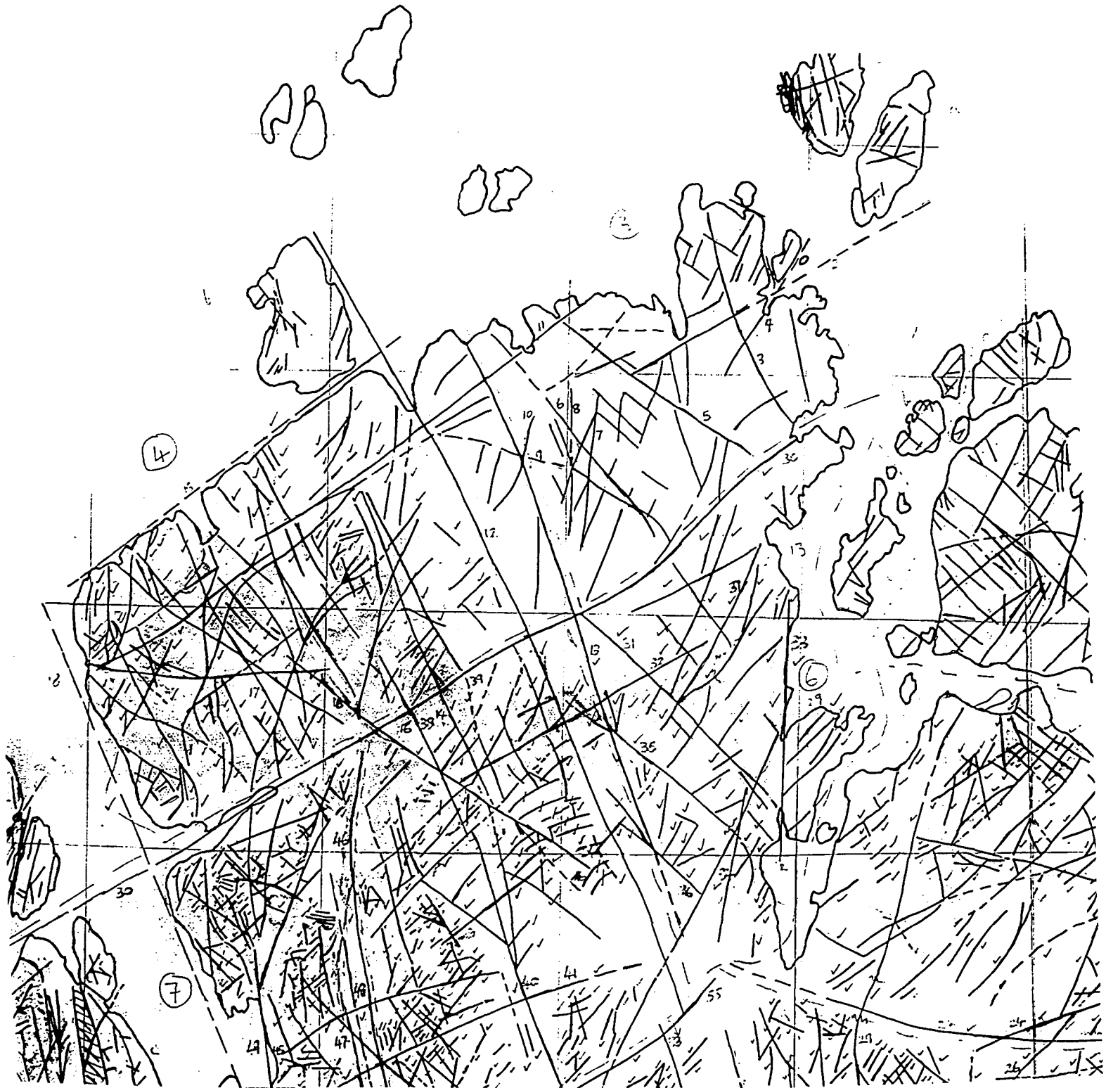
Figur 4a. Sprekkeretninger identifisert fra flyfotografier. Antall til venstre, lengder til høyre.
