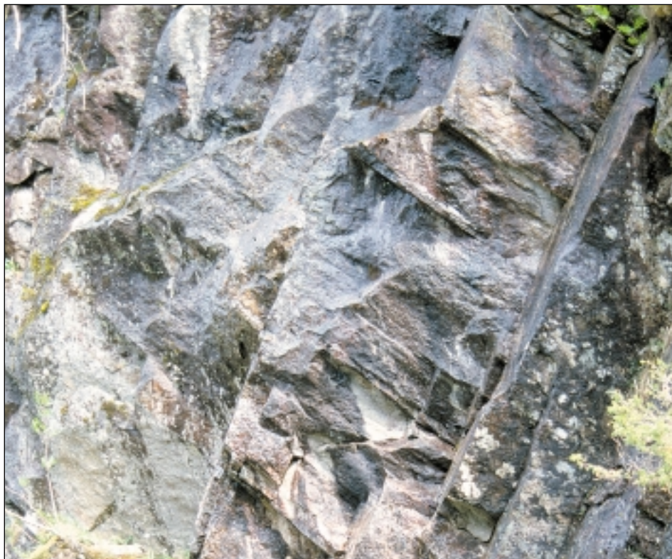
Figur 15. Typisk D-sone, med to steile bruddsett som har en minste vinkel på ca. 60 grader mellom settene. Dette gir den karakteristiske trinnformede, topografiske kanten av dette bruddlineamentet. Det er også enkelte lavvinklede brudd langs foliasjonen i bergarten.
