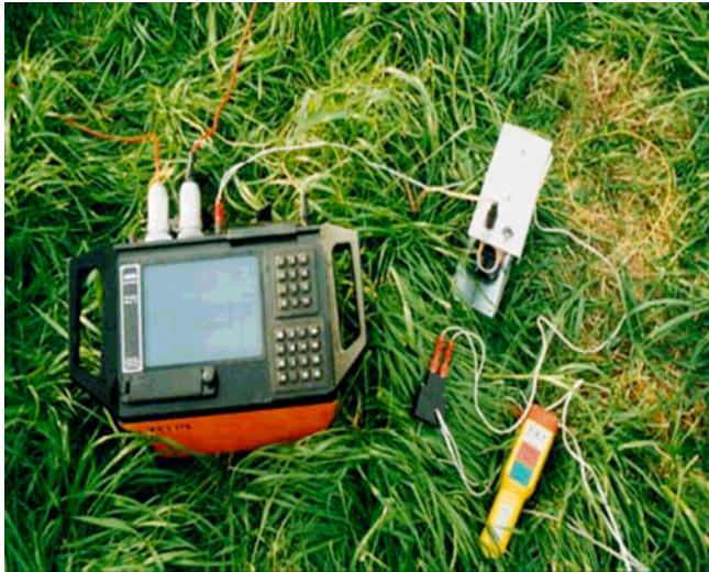
Bilde: Seismograf (24 kanaler), batteri, triggspole og avfyringsenhet.
