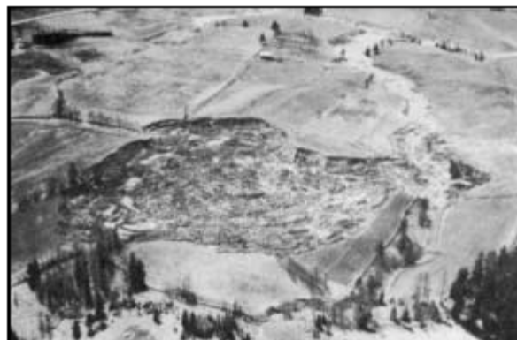
Figur 13 Kvikkleireraset ved Ullensaker 23.12.1953, viser pæreformet rasgrop. (Etter Janbu m.fl. 1993)
