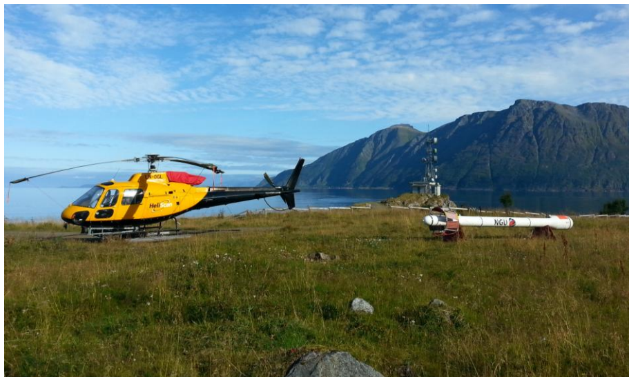
NGUs helikoptersystem for EM målinger.
