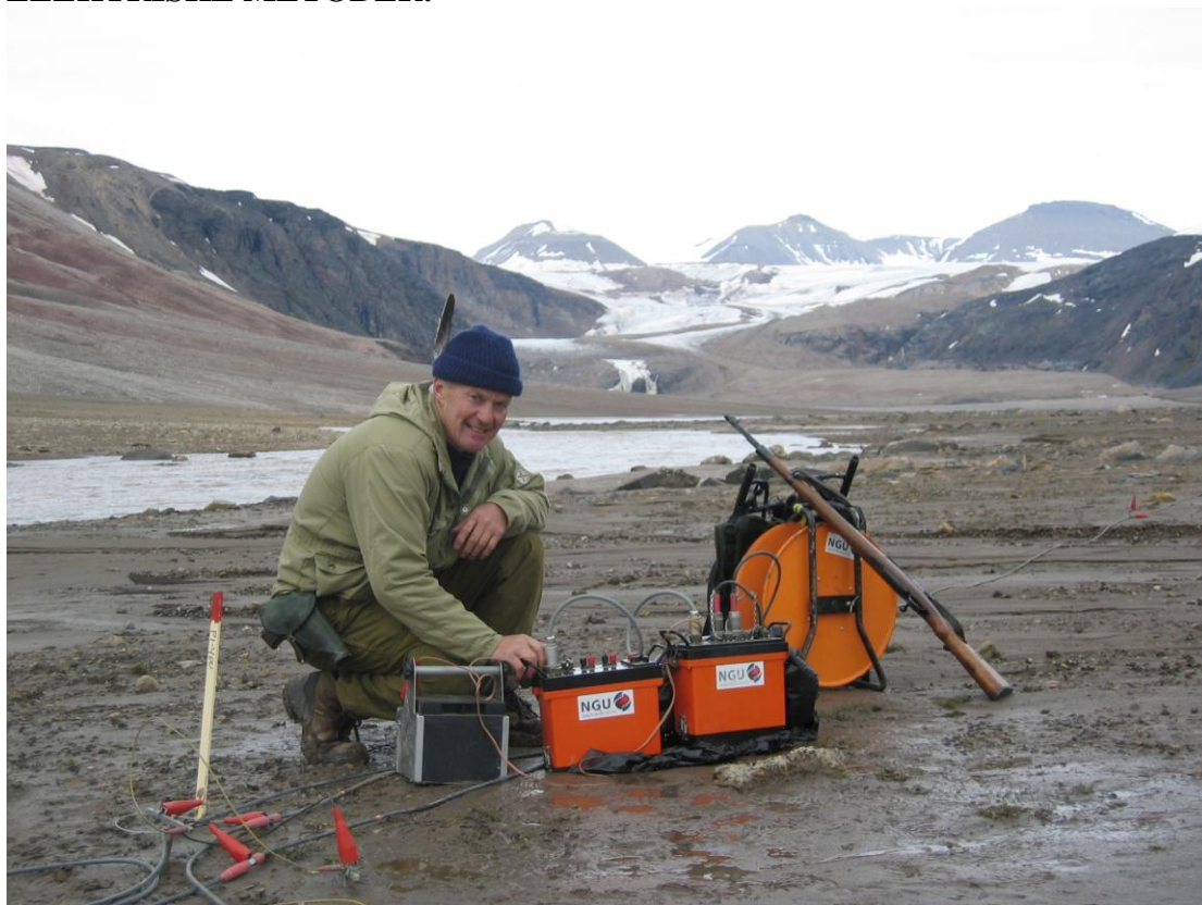
Utstyr for måling av 2D resistivitet. Bildet er fra Ebbadalen på Svalbard.
