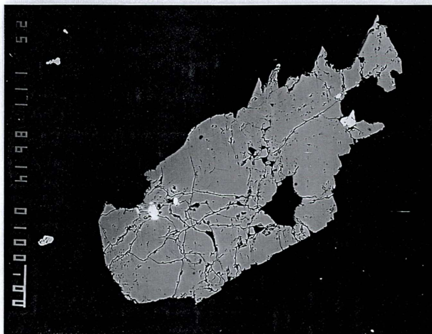
Fig. 28. Back-scatterbilde av genthelvin med inneslutninger av magnetitt, zirkon og thoritt. Analysenr. 8614-10 er fra dette genthelvinkornet. Skalastreken er 100 \mu\text{m} .
