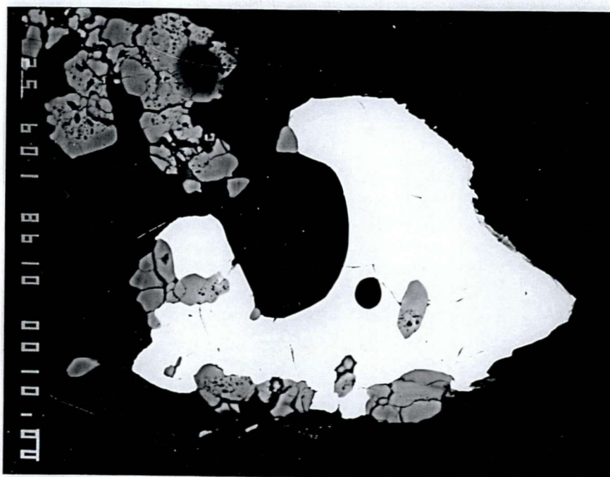
Fig. 91. Back-scatterbilde av tinnsten (hvit) og zirkon (grå). Skalastreken er 10 µm.
