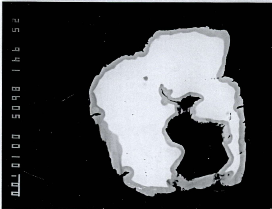
Fig. 77. Back-scatterbilde av fergusonitt. Analyse nr. 8605-12 er fra den lyse kjernen. Skalastreken er 10 \mu\text{m} .
