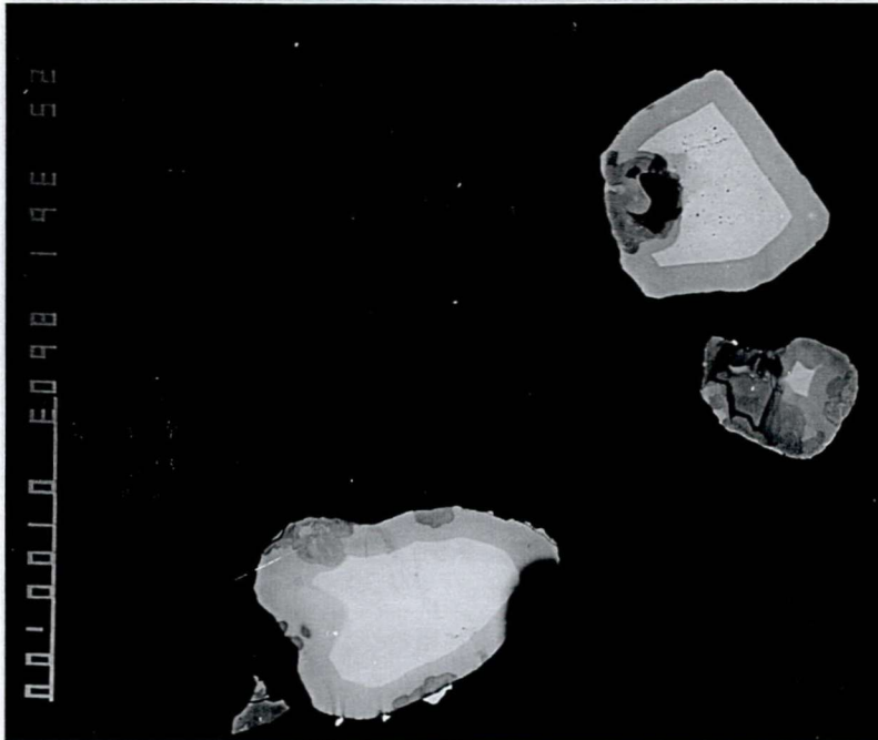
Fig. 56. Back-scatterbilde av sonert pyroklor. Mikroskopbilde i fig. 54. Skalastreken er 100 \mu\text{m} .
