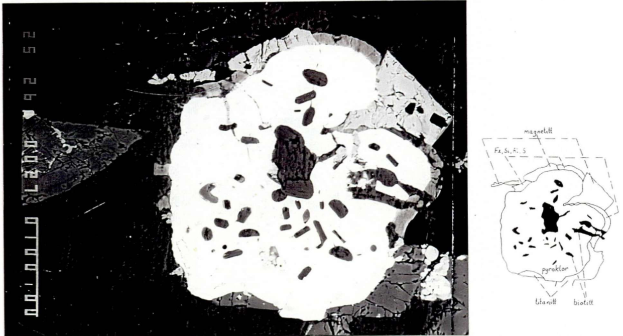
Fig. 49. Back-scatterbilde av pyrochlor med biotittinneslutninger og rand- sone av magnetitt og en Fe-Si-Al-S-fase. Skalastreken er 100 \mu\text{m} .
