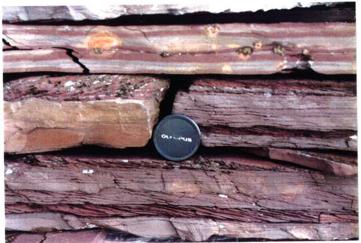
Foto 4 Ugunstig vinkel mellom lagnings- og kløvflater gir dårlig spalting.
