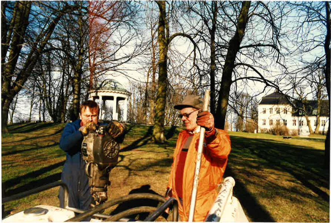
Figur 1. Prøvetaking av løsmasser med Pioneer bormaskin med gjennomstrømningsprøvetaker.
