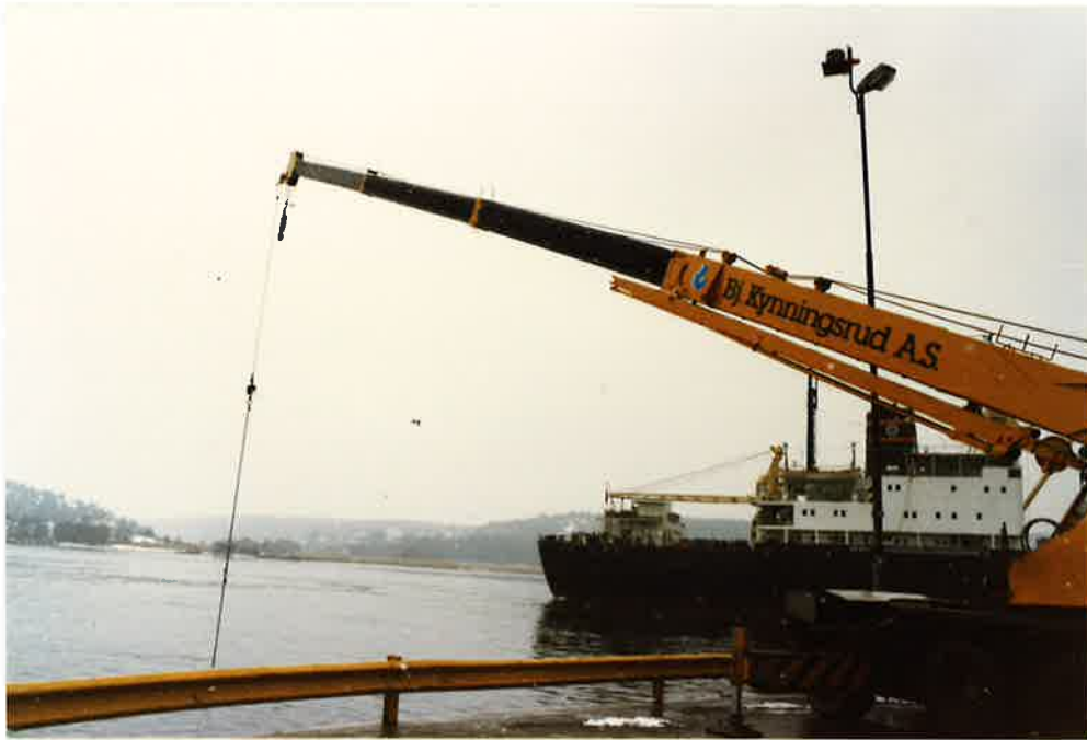
Figur 2 Prøvetaking av sedimentkjerner fra Glomma. Prøvetakeren ble sluppet ned i sedimentene ved hjelp av en mobilkran.
