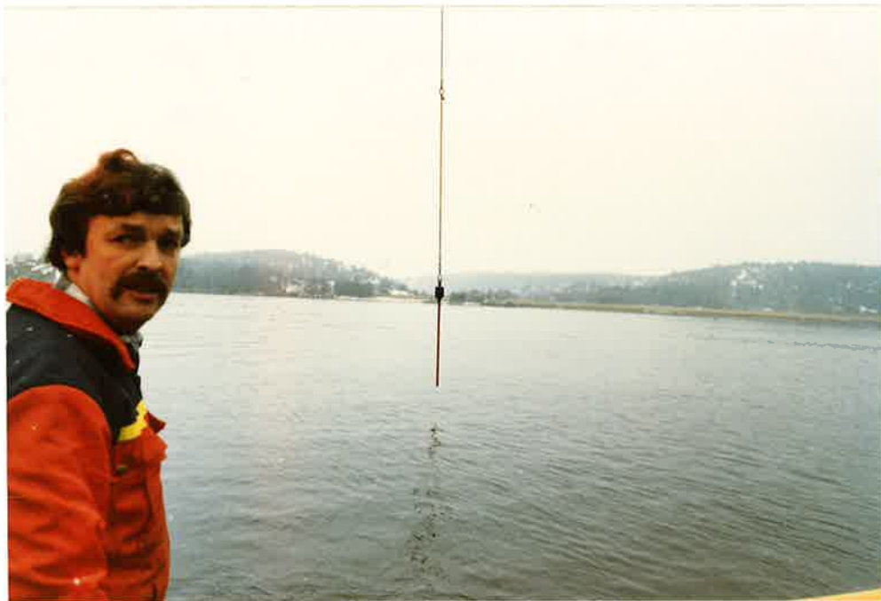
Figur 3 "Fallprøvetaker" for prøvetaking av sedimentkjerner fra Glomma. Indre diameter på prøvetakeren er 60 mm og lengden er 3 m. Prøvetakeren presses ned i sedimentene ved hjelp av 400 kg blylodd.
