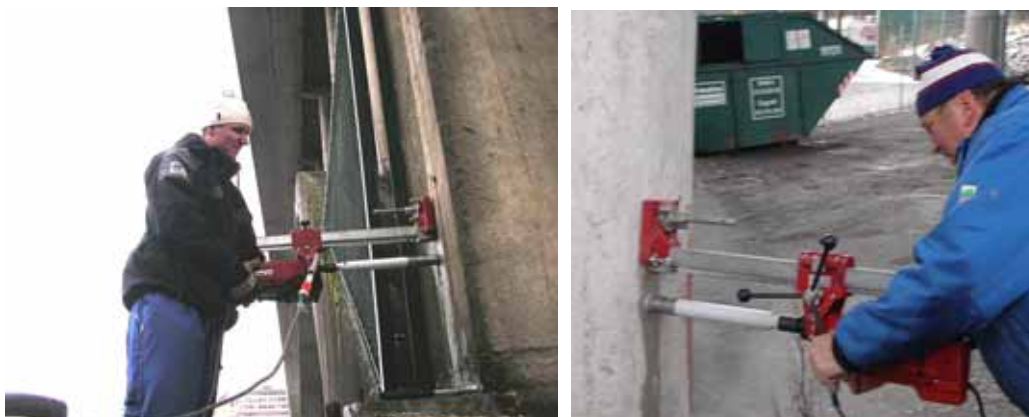
Figur 39. Ved hjelp av kjerneboring ble det tatt ut prøver av betong/murpuss på ca. 8 cm med diameter på 6 cm fra de eldste delene av Puddefjordsbrua.
