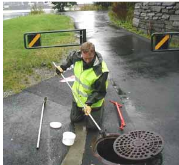
Figur 7. Kummene ble åpnet, og materialet ble hentet ut med en øseanretning i aluminium.
