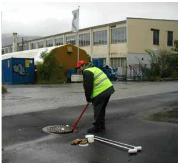
Figur 7. Kummene ble åpnet, og materialet ble hentet ut med en øseanretning i aluminium.
