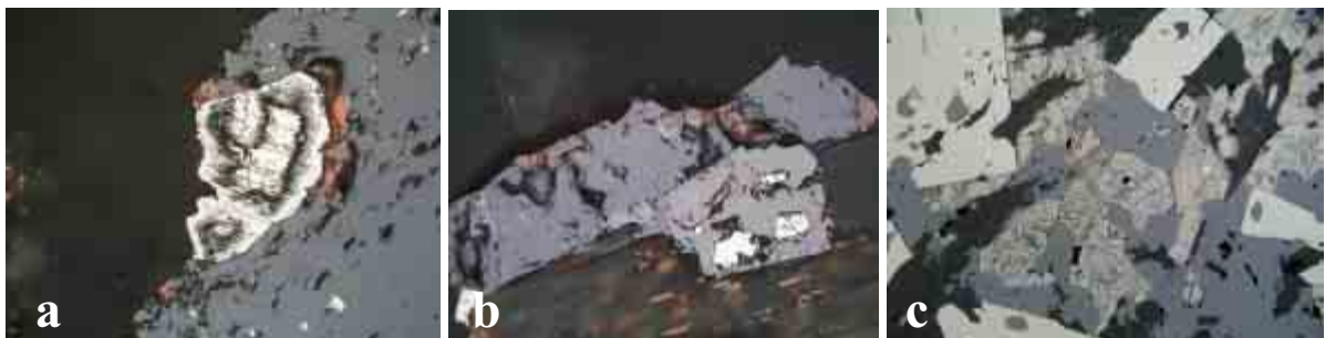
Figur 6: (a, b, c) Mikroskopbilder som viser svak omvandling av sinkblende (grå) langs kontakten mot omvandlet magnetkis. (b) Bildet viser magnetitt (lysgrå). Lengden på bildene representerer 2 mm.
