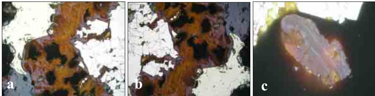
Figur 5: (a, b, c) Mikroskopbilder som viser total omvandling av magnetkis til goethitt (brunrød i figur 5c). I figur a og b kan en se at kantene av både svovelkis (kremhvit) og kobberkis (gulhvit, men lite synlig i disse bildene) er omvandlet til sekundær goethitt. Lengden på bildene a og b representerer 2 mm, c representerer 0.5mm.
