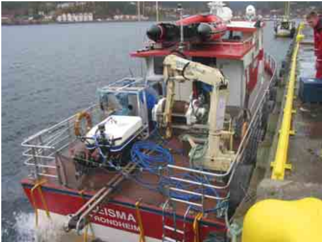
Figur 6. ROV-en med vinsj for kabel på dekket til F/F "Seisma"
