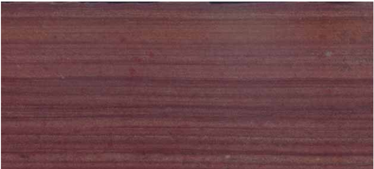
Figur 8: Polert plate av sandstein fra Skorabruddet. Snittflate vinkelrett lagning.
