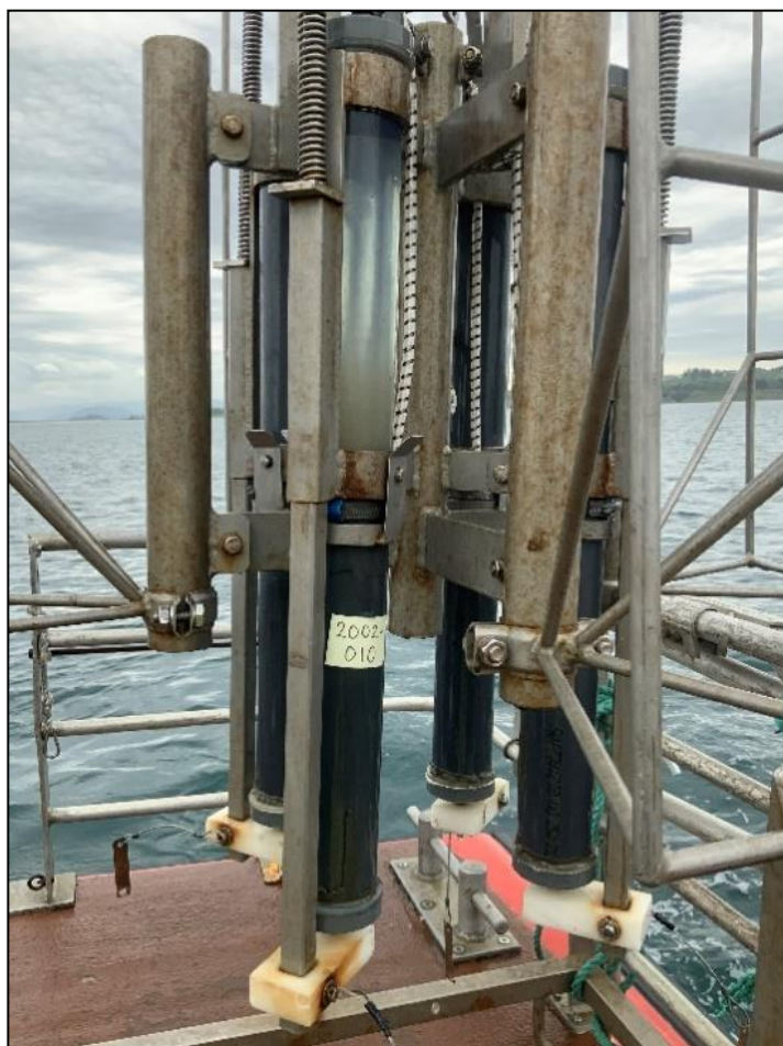
Figur 2. Prøvetaking med multicorer, som tar opptil 4 kjerner per stasjon. Lukkemekanismen utløses idet prøvetakeren treffer bunnen, og stenger topp og bunn av hvert rør. For hver stasjon er de øverste 2 cm av én kjerne brukt til analyser av sedimentenes kornfordeling og metallsammensetning.
