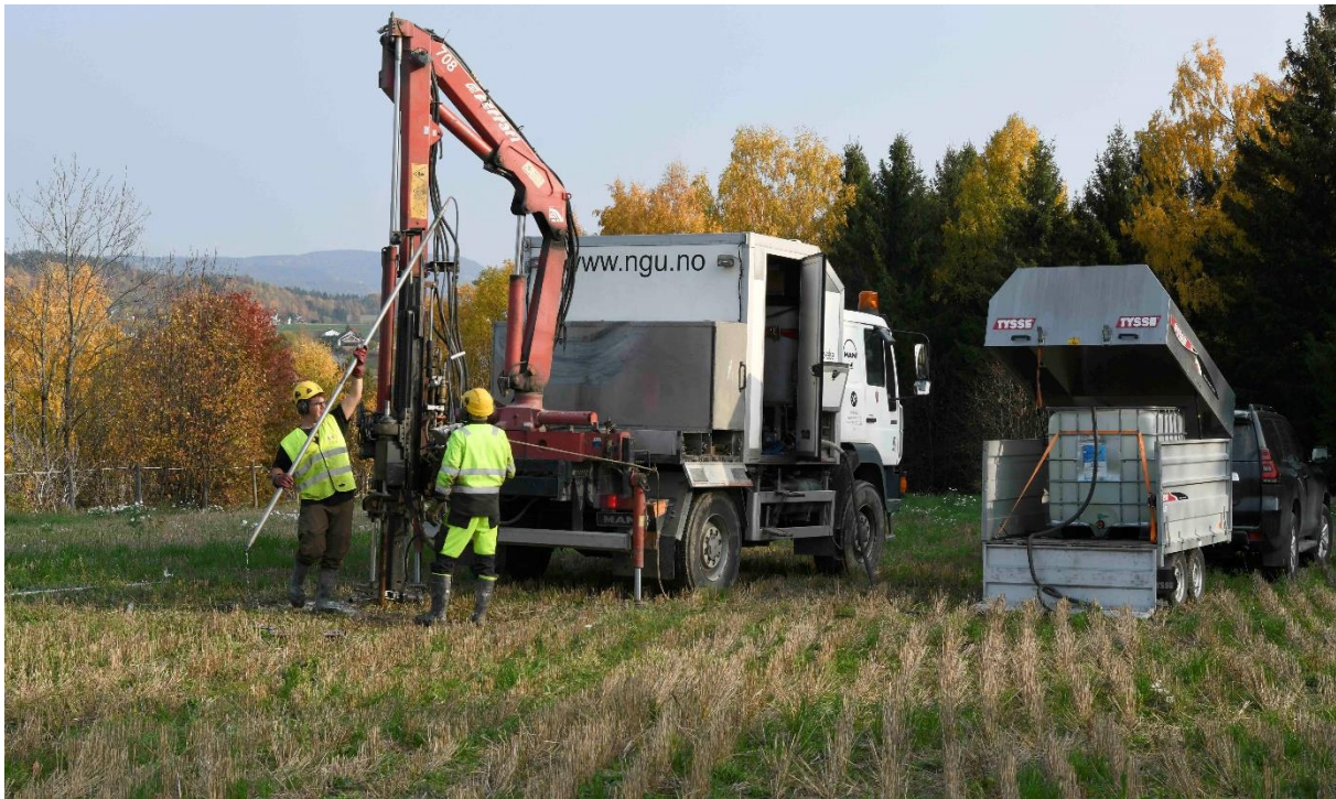
Figur 5: NGUs kjerneborerigg (LITO-rigg) i aksjon på Fen (Foto: S. Dahlgren).
