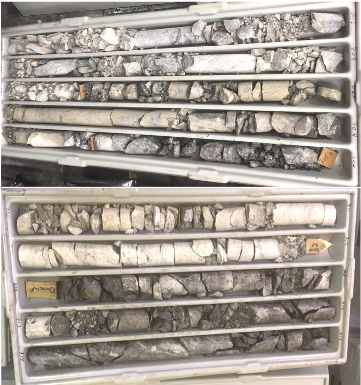
Figur 24: Bilder av kjerner fra LHKB-2. Øverst: Dyp 700 – 705 m. Nederst: Dyp 710 – 715 m.
