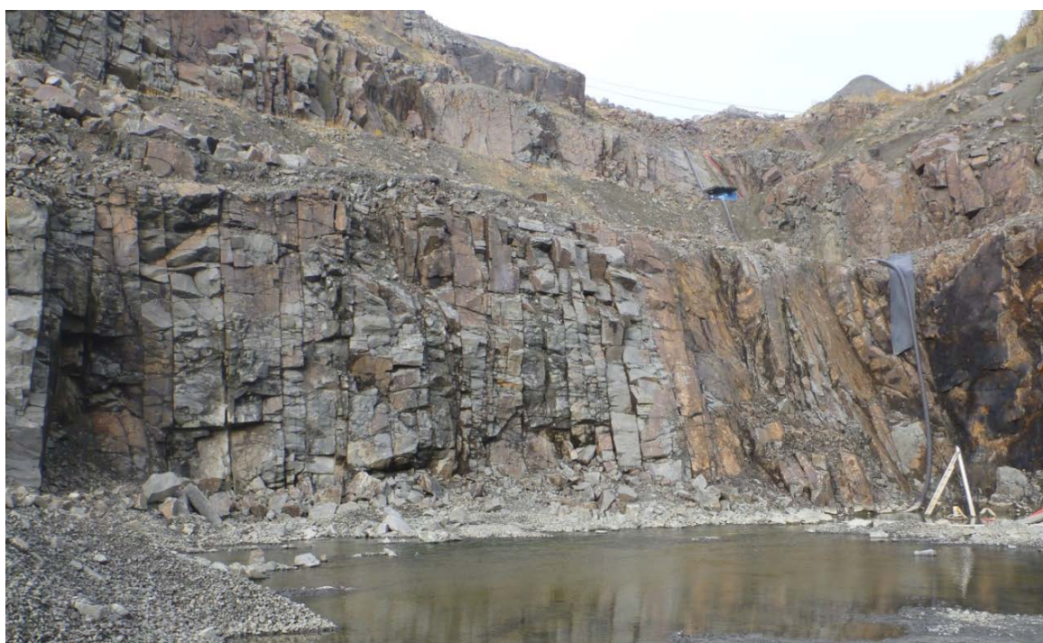
Figur 40 Bilde mot NV viser den dypeste delen av bruddet på dagens nivå -33 m i Vallnes dagbrudd med moderat oppsprukket massiv monzonoritt i vestveggen. Vannet i bruddet kommer i all hovedsak fra nedbør.
