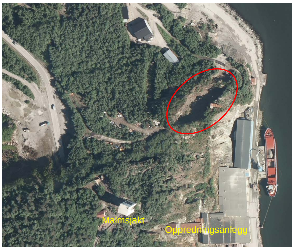
Figur 77 Luftfoto viser malmsjakt, oppredningsanlegg og dypvannskai. Den røde ringen viser kollapsområdet etter raset i gruen i 1974. Området dekket av bildet er avmerket på kartet i Figur 78.
