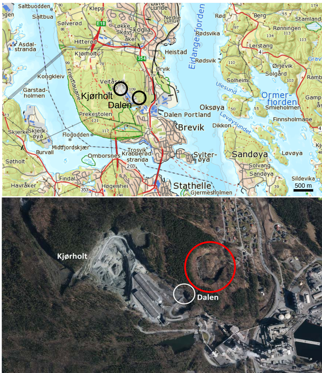
Figur 19 Kartutsnitt og luftfoto som viser beliggenhet av Dalen/Kjørholt gruve og Dalen dagbrudd i Brevik. Den røde ringen viser kollapsområdet etter raset i gruva i oktober 1976. (kilde: Kartverket).
