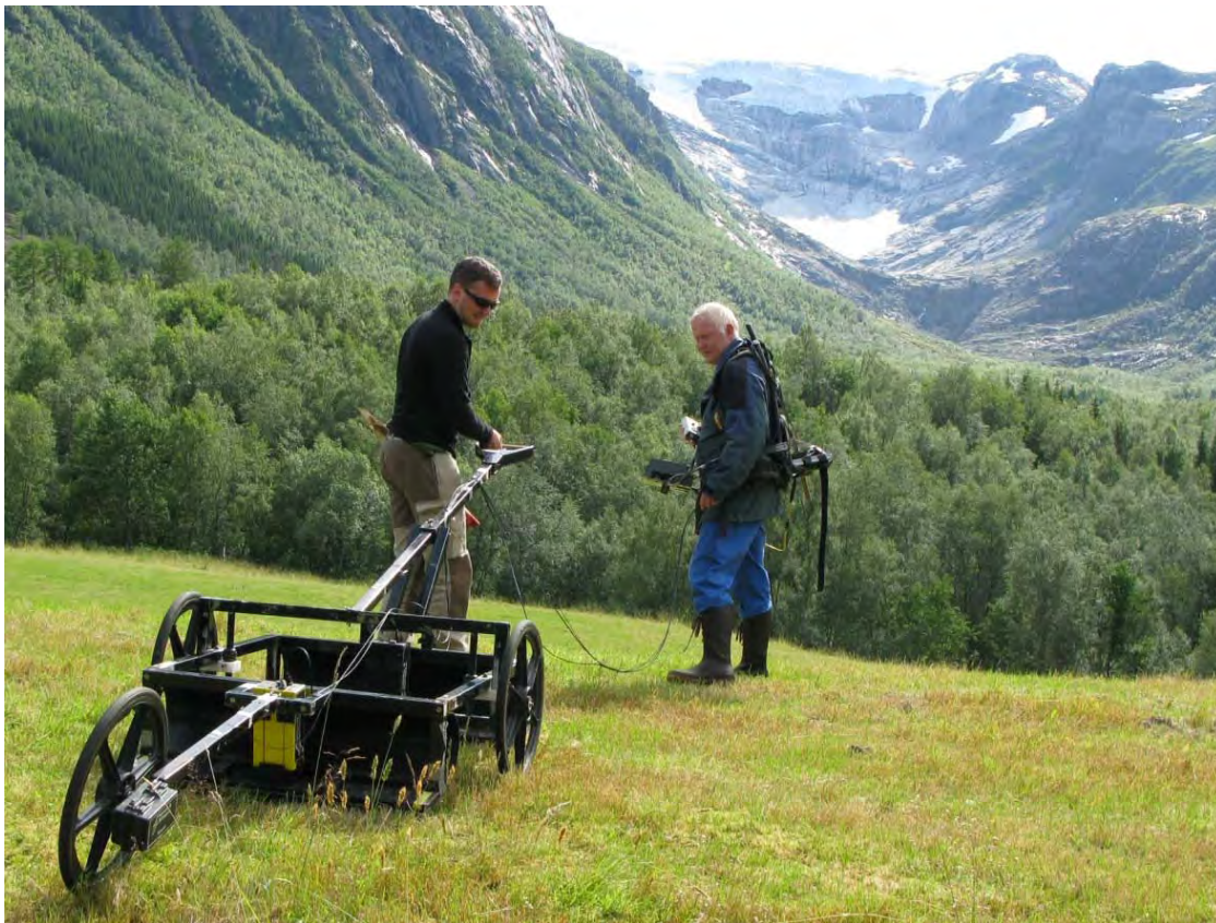
Figur 1: Georadar under måling i Fonndalen. Bakerst et odometerhjul som trigger målingene ved forhåndsinnstilte intervall. På vognen sender og mottaker med tilhørende antenner, her med senterfrekvens 100 MHz. Operatør (med bæremeis) har datalogger i front. Dataloggeren styrer målingene, viser måledata og lagrer måledata på fil..
