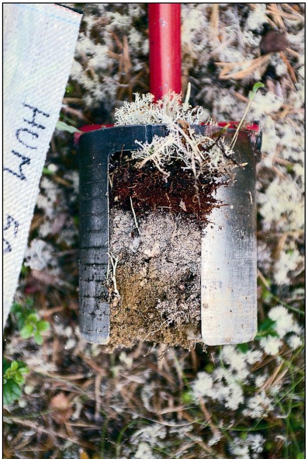
Figur 4. Prøvetaking med "topsoiler".
