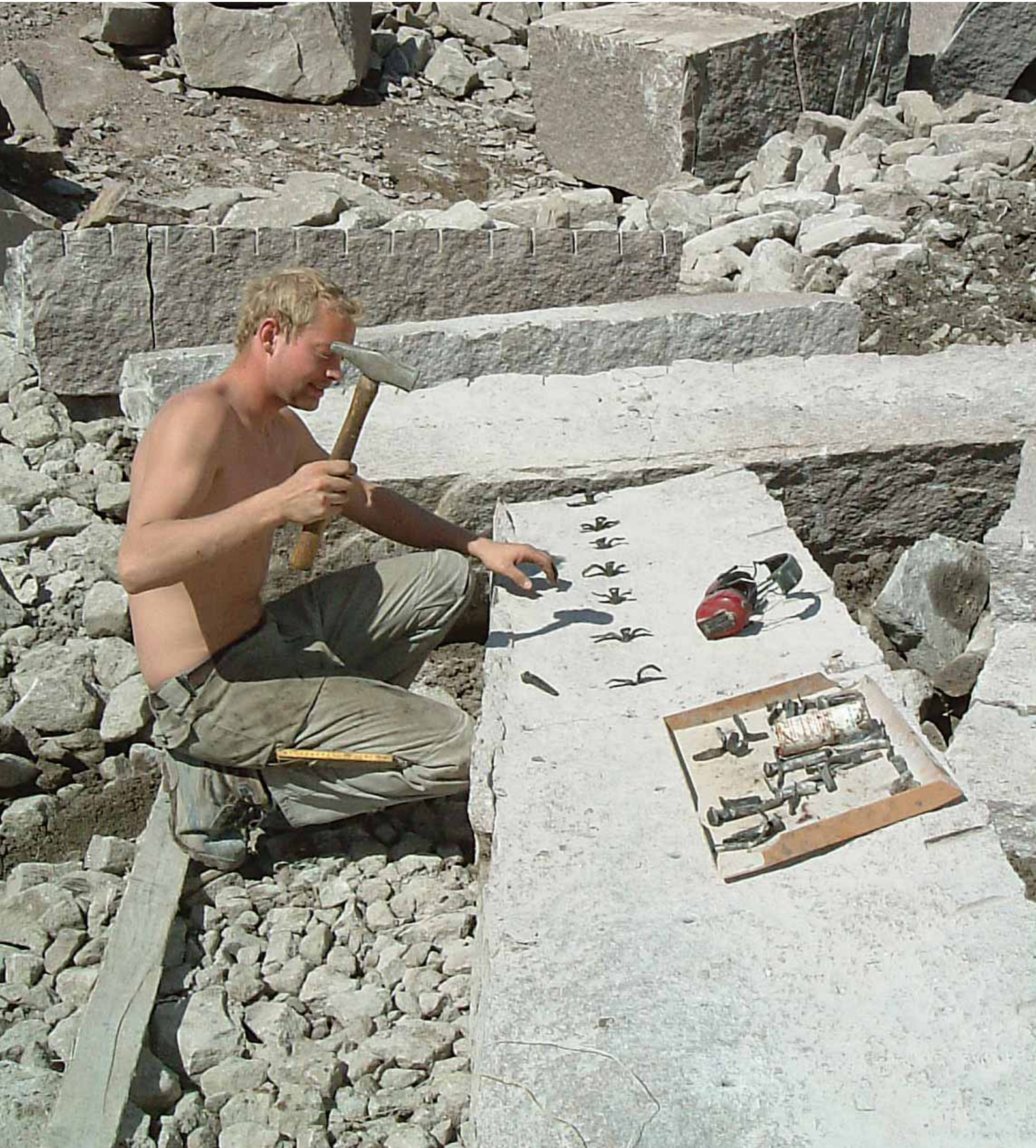
Kantsteinproduksjon på Grorud i Oslo i rød syenitt, Grorud Granitt og Skifer A/S. Foto: Peer-Richard Neeb.
