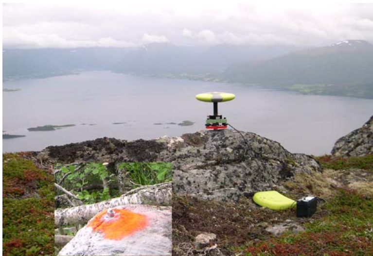
Figur 8: Måling av bevegelse med bruk av GPS. Fra Oppstadhornet i Møre og Romsdal.
