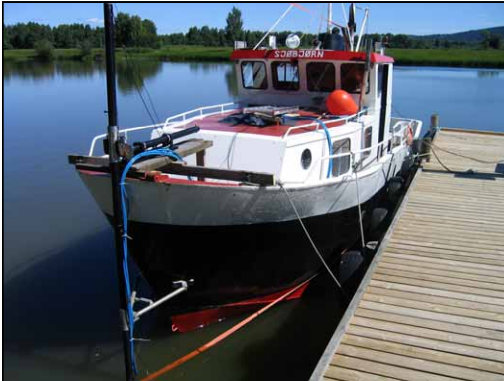
Fig. 2 Sonaren montert i baugen på Sjøbjørn.
