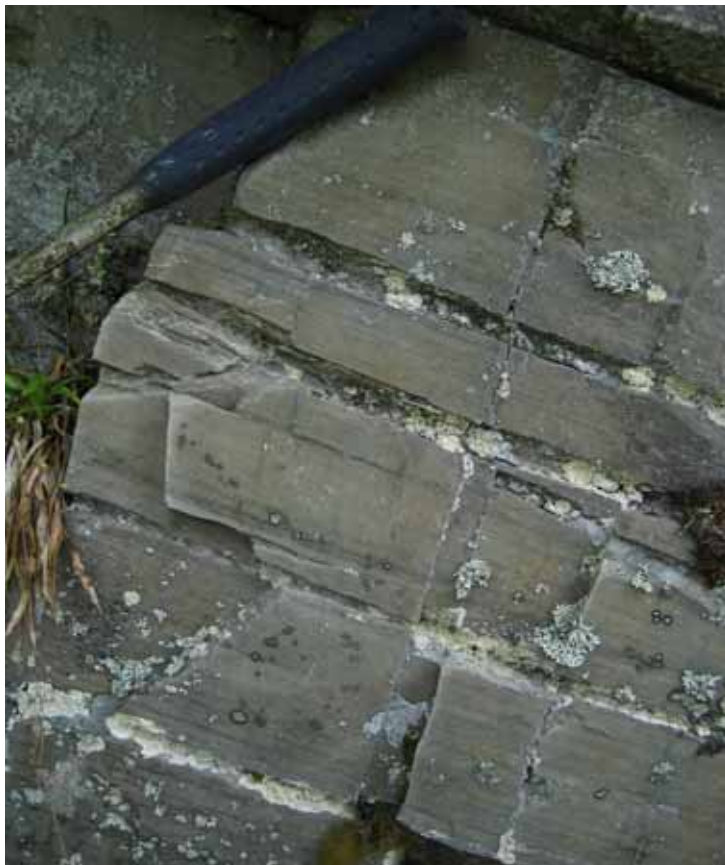
Figur 27: Nærbilde av skiferen i Figur 26. Bildet viser tydelig laminering på cm-skala som skyldes endring i mineralinnhold, hovedsakelig kvarts og feltspat.
