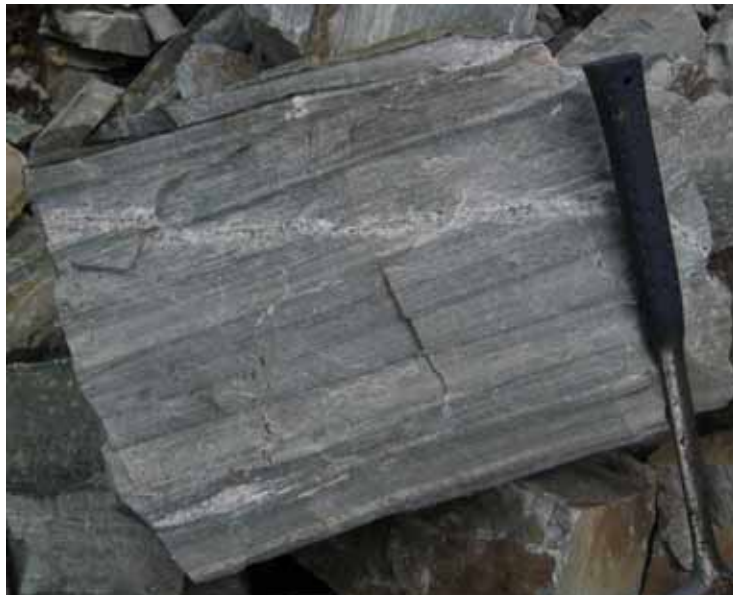
Figur 17: Røsning i feltspat-kvartsittskifer v/Stykket (UTM 508730, 6593730). Legg merke til varierende grad av spaltbarhet. Nærbildet nederst viser dekorativ bånding i bergarten.
