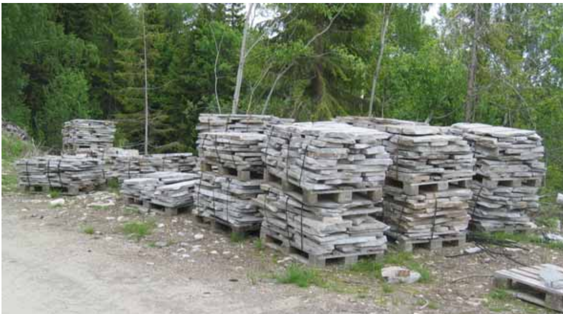
Figur 5: Paller med skiferheller ved Grasbottbruddet.
