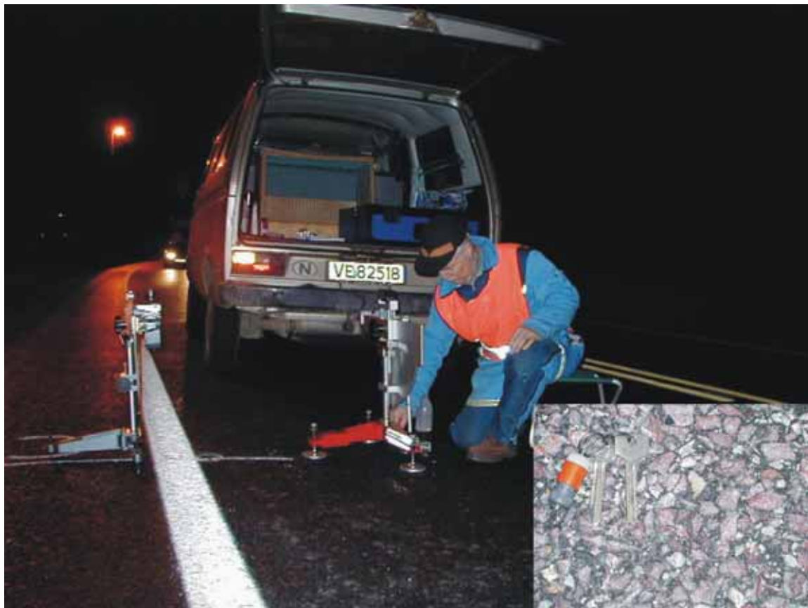
Figur 3. Pendelmålinger på E6-Klett. Innfelt "jaspisdekket" med eksponert grovtillslag.
