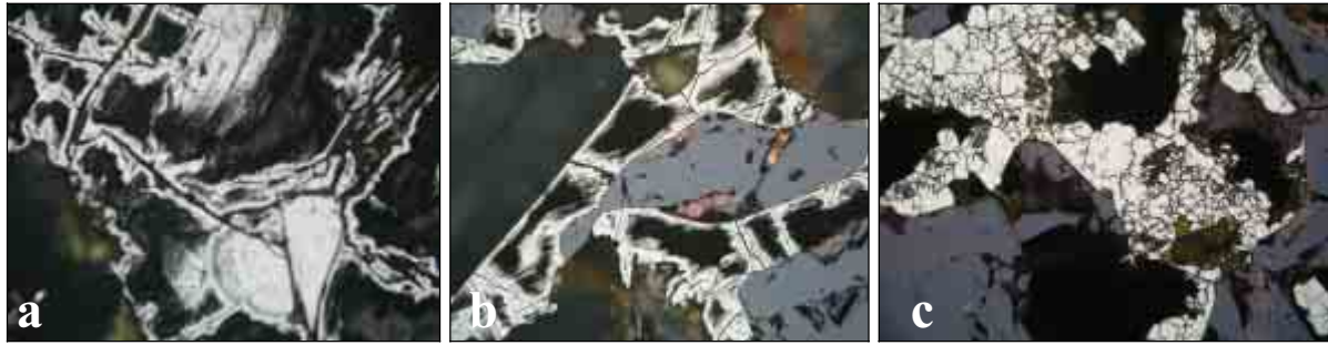
Figur 4: (a, b) Mikroskopbilder som viser såkalt "markasittomvandling" (tidligere magnetkis, gråhvit) til ikke-krySTALLINE jernhydroksider (sort). (c) Svovelkis (lys grå) som tidligere sameksisterte med magnetkis er bevart. Lengden på bildene representerer 2 mm.
