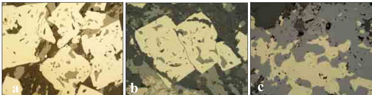
Figur 2: Mikroskopbilder tatt i reflektert lys av sinkmalm. (a) Grovkornet svovelkis (lys grågul) med inneslutninger av sinkblende (mørkgrå) og blyglans (lysgrå). (b) Sammensveisede svovelkiskorn med brudd innfylt med kobberkis (grågul). (c) Grovkornet masse av sinkblende (grå) med inneslutninger av kobberkis (grågul). De mørke inneslutningene i sinkblendene er magnetitt. Lengden på bildene representerer 4 mm.
