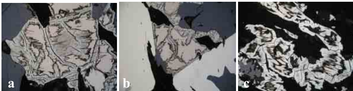
Figur 3: (a, b, c) Mikroskopbilder som viser karakteristisk omvandling av magnetkis (svakt rosa) til markasitt (gråhvit) langs sprekker og korn grenser. Merk i figur 3b sterkt omvandlet magnetkis sammenlignet med 'inert' uomvandlet svovelkis (grågul). Lengden på bildene representerer 2 mm.
