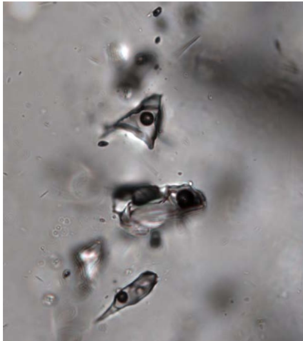
Fig. 4. Nærbilde av væskeinneslutninger med mørk boble av vanddamp i lav-salin vandig løsning langs forseglet mikrosprekk. Største dimensjon på væskeinneslutningene er 20 \mu\text{m} .
