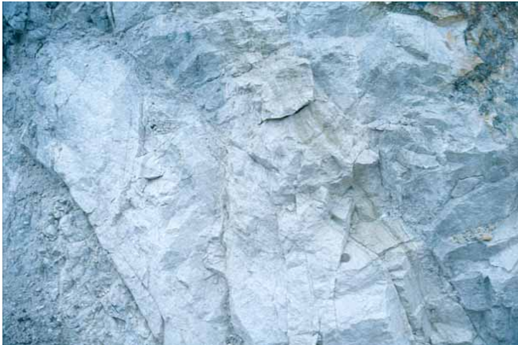
Figur 7. Fullstendig omdannet kritthvit anortositt, som er ettertraktet på grunn av sitt potensial for f.eks. fyllstoff og keramisk råstoff. Veiprofil mellom Hellvik og Eike.
