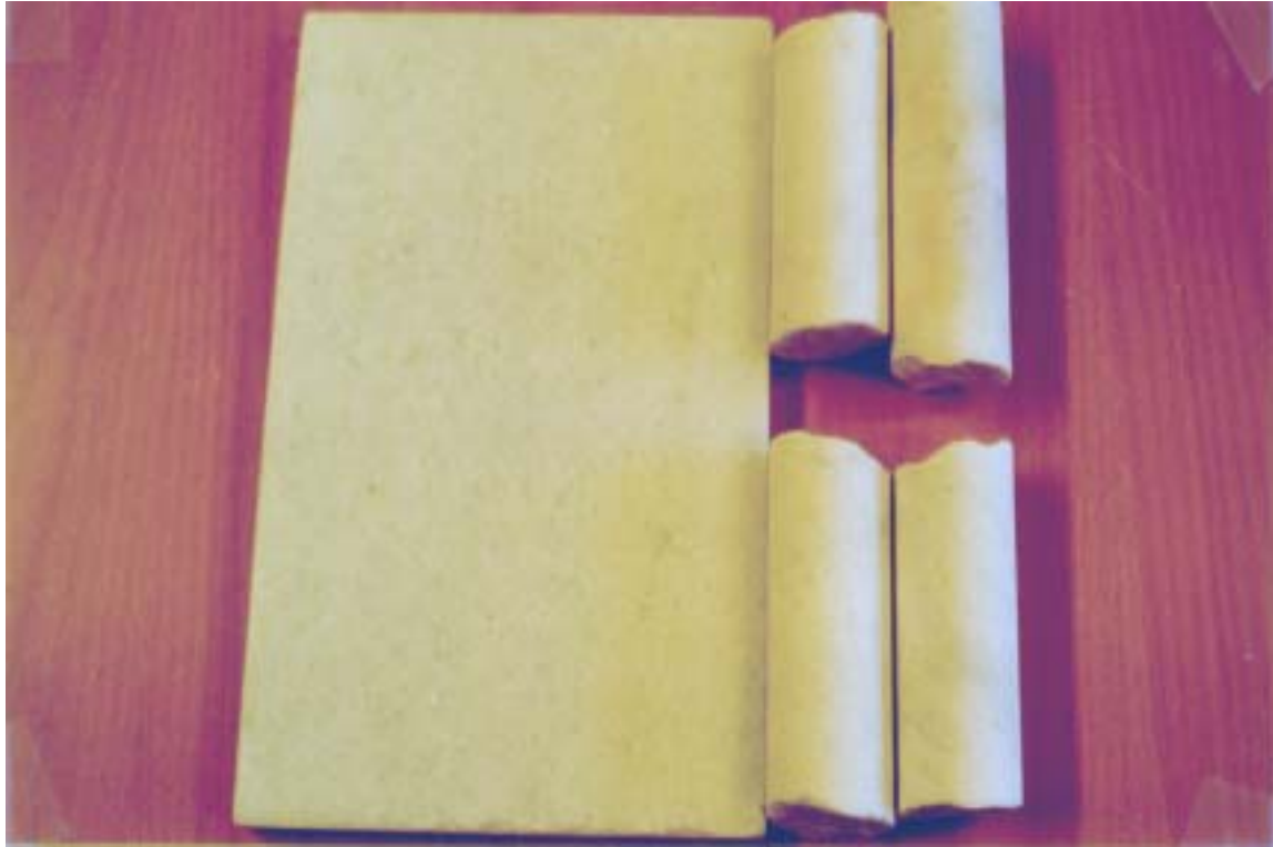
Fig. 7: Borkjerner av i finkornet dolomittmarmor fra boring i Buvika i Sørfold kommune. Kjernene er utlånt av Hammerfall Dolomitt AS. Kjernene er ubearbeidet.
