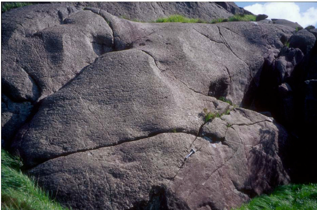
Figur 6. Parti fra nordvestsiden og nedre del av subområde c . Hammeren ligger på kontakten mot en sone av dårlig kvalitet anortositt med opptreden mellom område b og c. Merk forskjellen i overflatetekstur.
