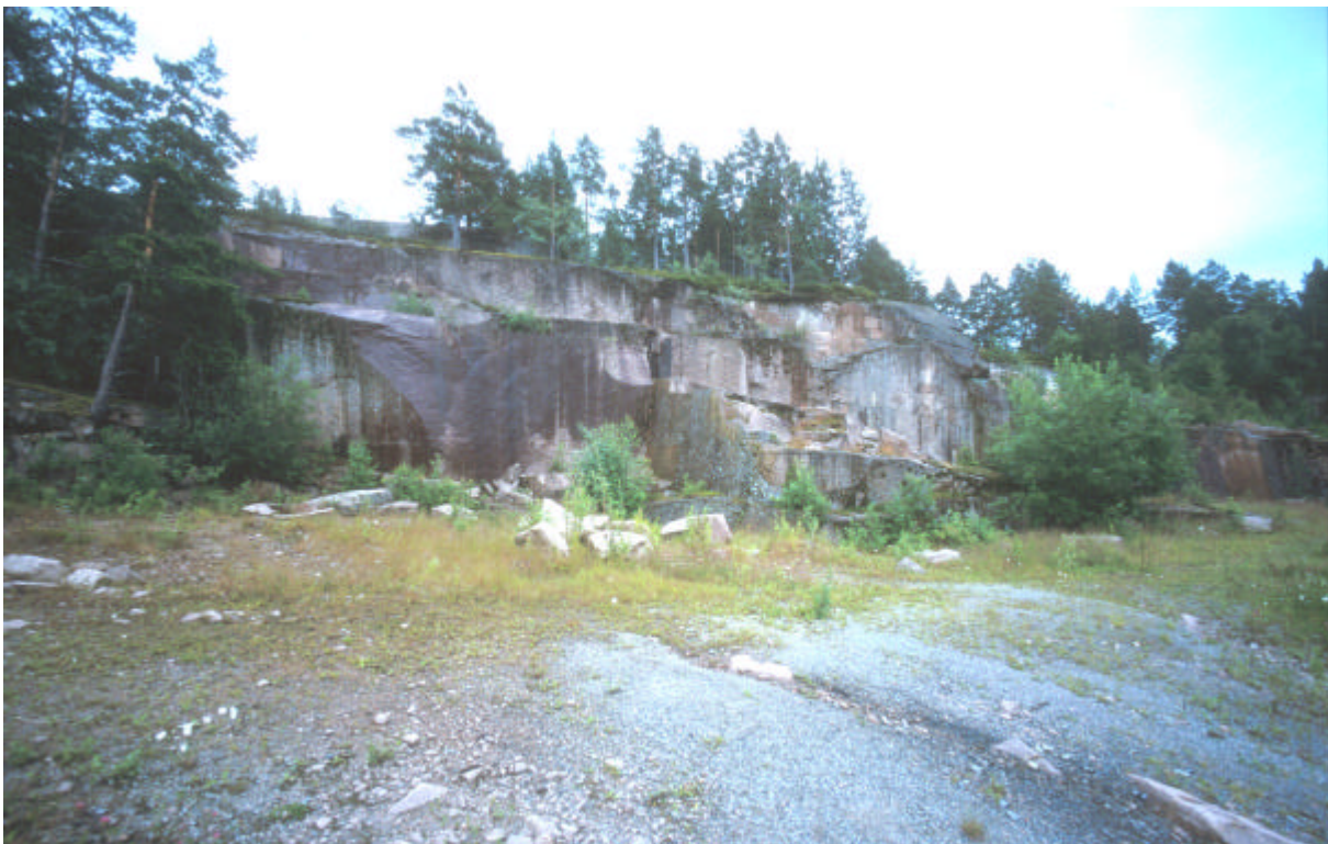
Figur 4. Fra hovedbruddområdet ved Kinnartangen, her ble det drevet på stein som ga meget variabel blokkstørrelse.
